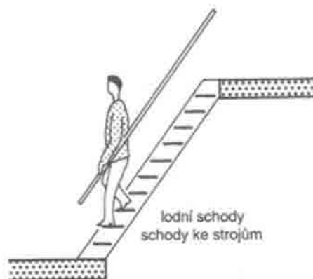
④ Žebříkové schody se zábradlím
