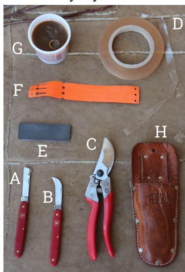
• (A) Štepársky/očkovací nôž, (B) Ovocinárska žabka, (C) Dvojsečné nožnice, (D) Štepárska páska, (E) Veľmi jemný brúsny kameň, (F) Označovacie štítky, (G) Štepársky vosk, (H) Puzdro na nožnice
